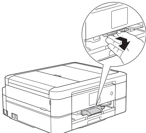
5. ディスクトレイをディスクガイドに差し込み、ディスクトレイの端が、本体の△の目印に合う位置まで、ディスクトレイを挿入します。
